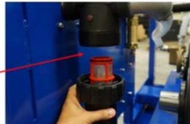
Figura 6.1 - Inspección / limpieza del filtro de agua
