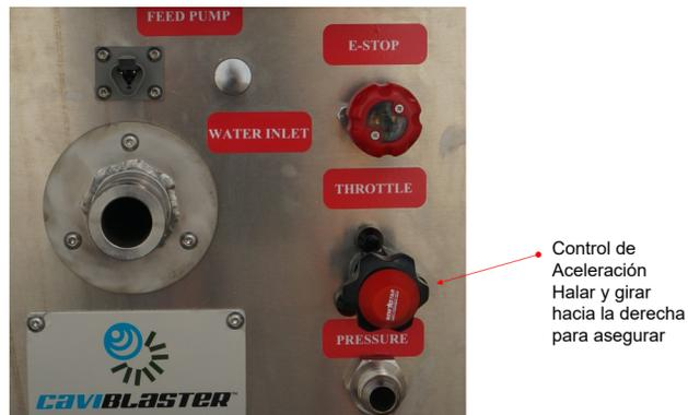
Figura 5.1 - Control del acelerador del motor
