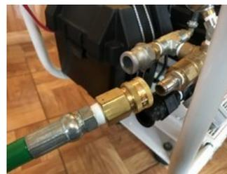
l'extrémité. Le CaviBlaster® 1325-G peut fournir la pression requise en utilisant jusqu'à 300 pieds de tuyau en caoutchouc de ½ " de diamètre ou 600 pieds de tuyau en thermoplastique. **Utiliser de plus grandes longueurs ou des diamètres plus petits de ceux-ci peuvent dégrader les performances** Si plus de longueurs sont nécessaire, un tuyau de plus grand diamètre doit être utilisé.
