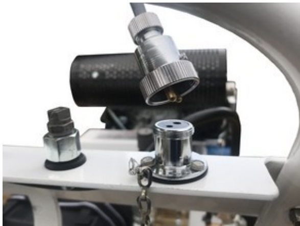
Figura # 17 - Conexión de la bomba de alimentación
