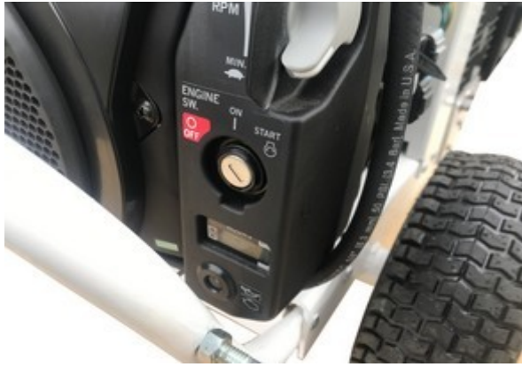
Figura # 19 - Panel de encendido
