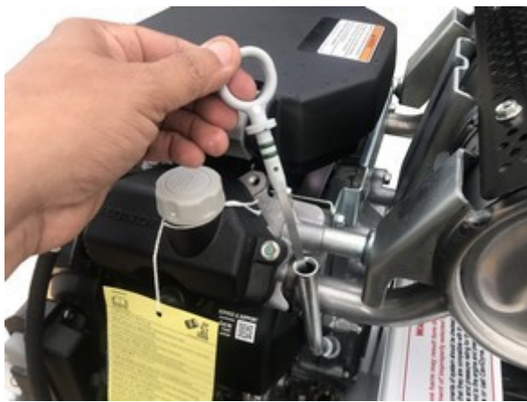
Figura # 3 - Nivel de aceite en el motor
