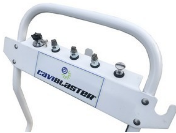
Figura # 18 - Interruptor encendido / apagado de la bomba de alimentación
