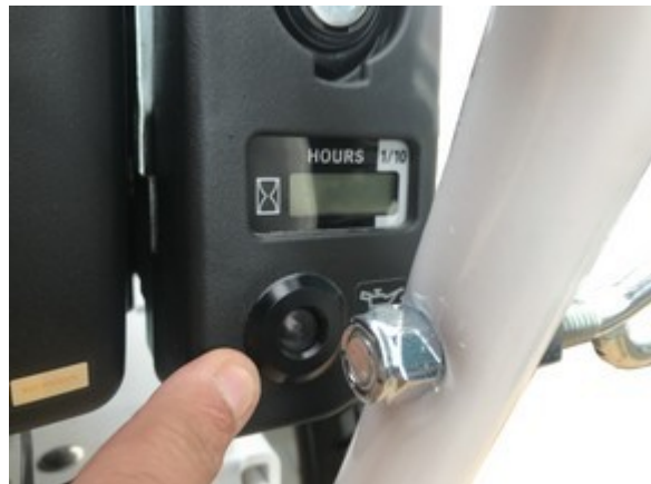
Figura # 24: advertencia de nivel bajo de aceite
