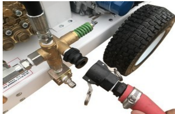
Figura # 10 - Conexión de la manguera de by-pass
