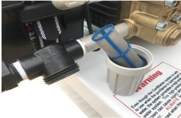
Figura # 1 - Filtro de agua de entrada
