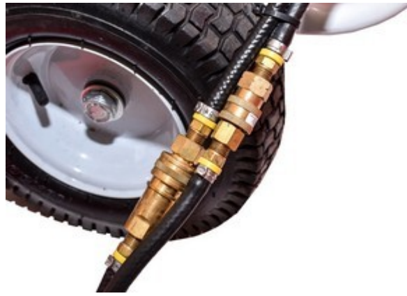
Figura # 14 - Conexión de las líneas de combustible
