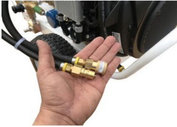
Figura # 13 – Doble línea de combustible
