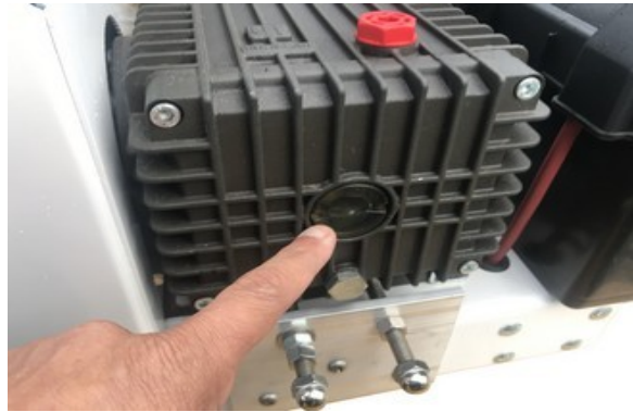
Figura # 2 - Nivel de aceite en la bomba
