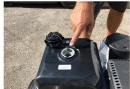
4. Llene el (los) aceite (s) lubricante (s) hasta el (los) nivel (es) adecuado (s) en la bomba de presión (Tapa amarilla en la bomba) (Figura-5) y en el motor (Tapa amarilla en la tapa del cabezal) (Figura-6) según los manuales de operación del fabricante.
